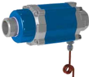
Клапан серии МН предназначен для гидравлической балансировки и стабилизации расхода, в первую очередь, в системах теплых полов многоэтажных зданий. Быстрый перепад давления в сложных системах приводит к значительным отклонением фактического расхода в петлях теплого пола от расчетного.
